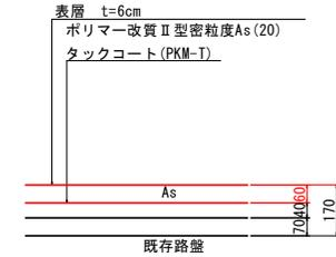
舗装段差すり付け詳細図 S=1/10
