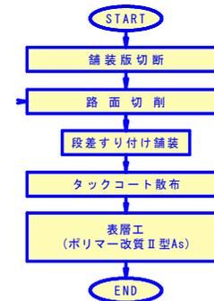
※1日の作業作業終了時は、既設舗装との段差すり付け処理は必ず行うこと。
